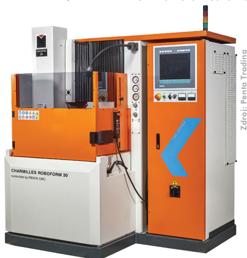
Elektroerozivní hloubička Charmilles Roboform 30 s řídicím systémem Penta CNC.
