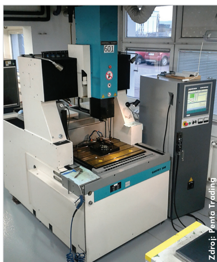
Také tato starší EDM hloubička Ingersoll Gantry 300 prošla inovací a byla vybavena novým řídicím systémem.
