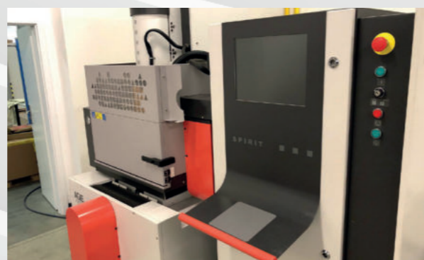
EDM hloubička s malou zástavbovou plochou PENTA A2 CNC
