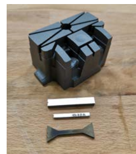
Příklady zkušebních tělísek, které jsou na stroji vyřezávány pro analýzu materiálové struktury dílců vyráběných hybridní technologií
