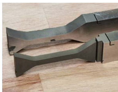
Příklady zkušebních tělísek, které jsou na stroji vyřezávány pro analýzu materiálové struktury dílců vyráběných hybridní technologií
