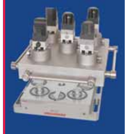
Nerezové otočné stoly a A - osi pre rezačky a hĺbičky
