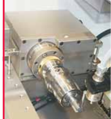
Nerezové otočné stoly a A - osi pre rezačky a hĺbičky
