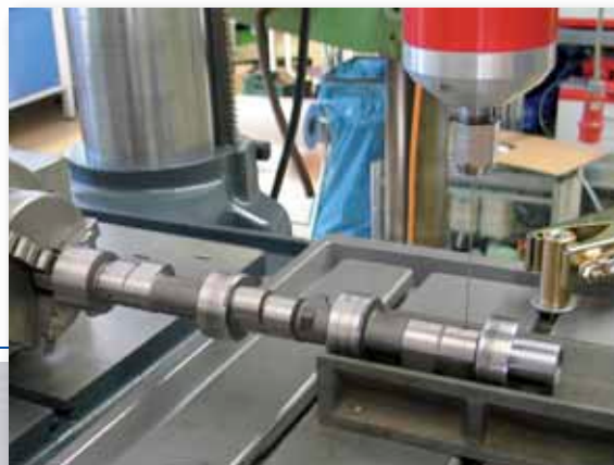
Erodování vačkové hřídele.
