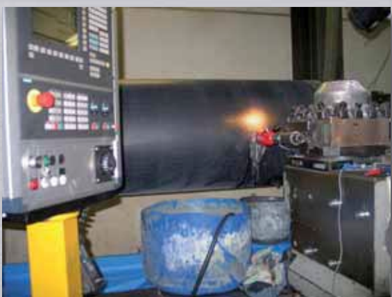
Erodování na CNC soustruhu. Regulace posuvu nastává manuálně pomocí ručního kolečka.
