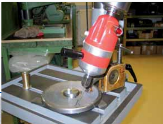
Erodování šikmých vrтанých otvorů.
